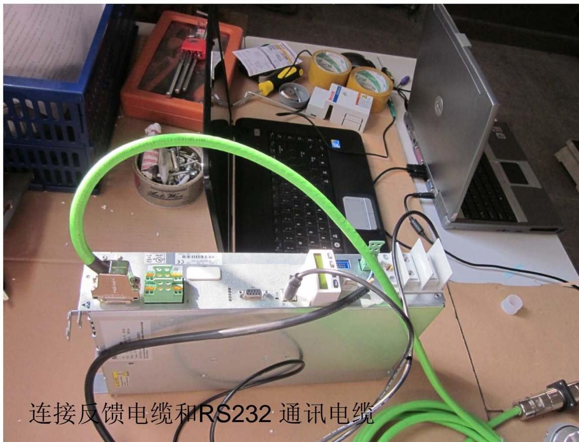
连接反馈电缆和RS232 通讯电缆
